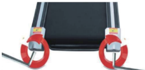
Figure B Méthode d'ajustement pour la bande de marche se décalant vers la droite
